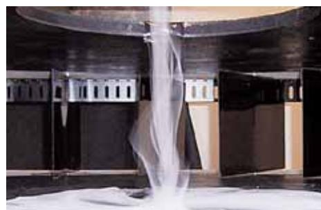
図3 竜巻状旋回流発生装置による可視化実験
