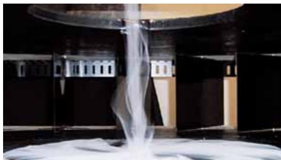
図3 竜巻デモンストレータによる可視化実験の様子
