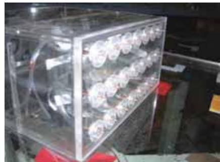
写真1 模型壁面に設置したIrwin's surface wind sensor
