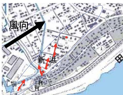
図3 被害状況(矢印は屋根瓦などの飛散方向を示す)
