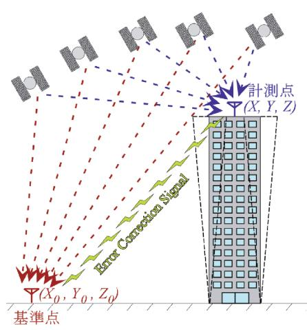
図1 RTK-GPSの概念図
