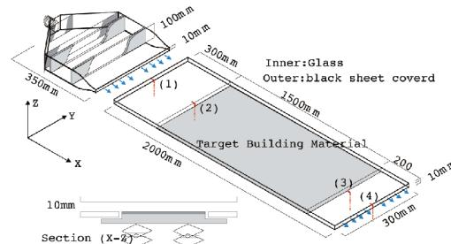
図2 ガラス製境界層型チャンバー概要と建材設置の様子
