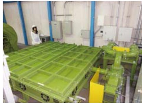
図7 試験装置概要(左:加圧部, 右:圧力調整部)
