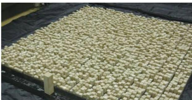
写真 3 東京の臨海都市部をモデルとした風洞実験
