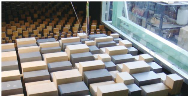
写真 2 香港の密集市街地をモデルとした風洞実験
