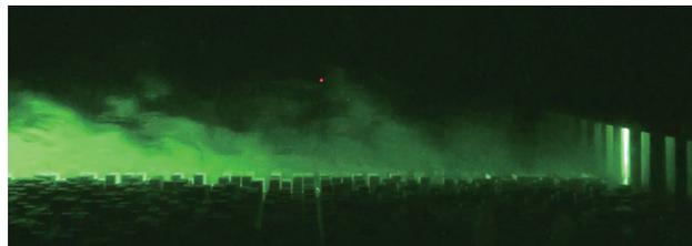
写真 4 臨海部の高層建物群によって生じる「鉛直方向の風の道」の可視化
