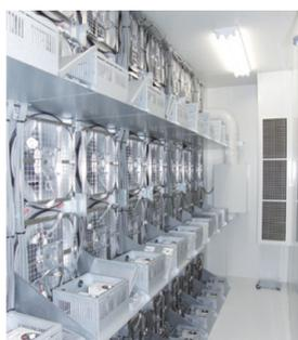
写真 1 気流生成装置
