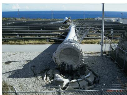
基礎生じた損傷による倒壊
