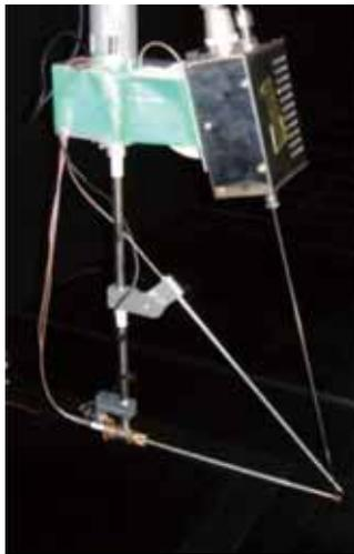
図15 風速・濃度・温度の同時測定システム
