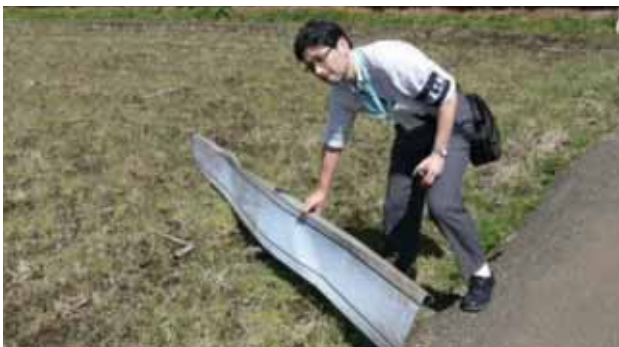
写真2 北北東へ100m程度飛散した葺材
