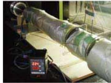
図11 熱線流速計の非等温較正装置
