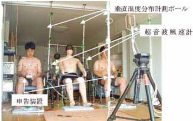
図7 温熱環境評価の実測風景
